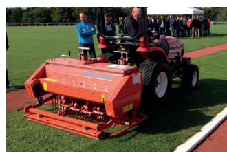
Aération sol carottage
