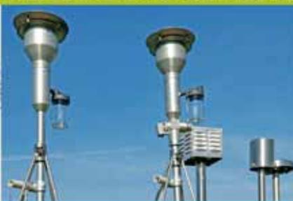
Capteurs de mesure de la qualité de l'air.
