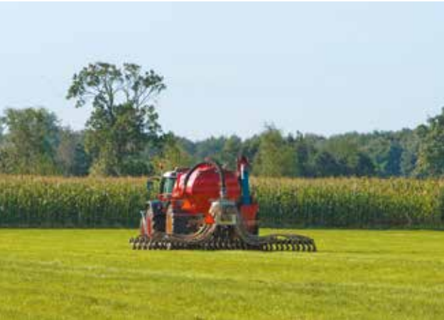
L'épandage du digestat par pendillard permet de limiter les émissions d'ammoniac car le fertilisant n'est plus projeté dans l'air et est mieux absorbé par le sol.
